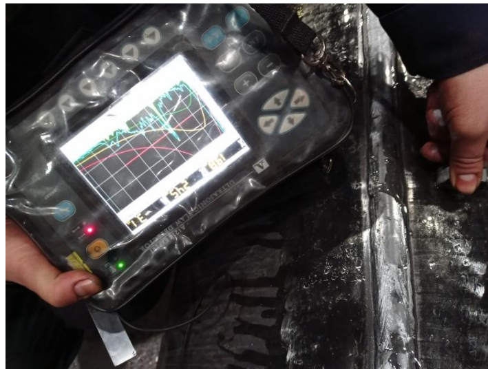
Рис. 11 Эхо-сигнал от несплошности
